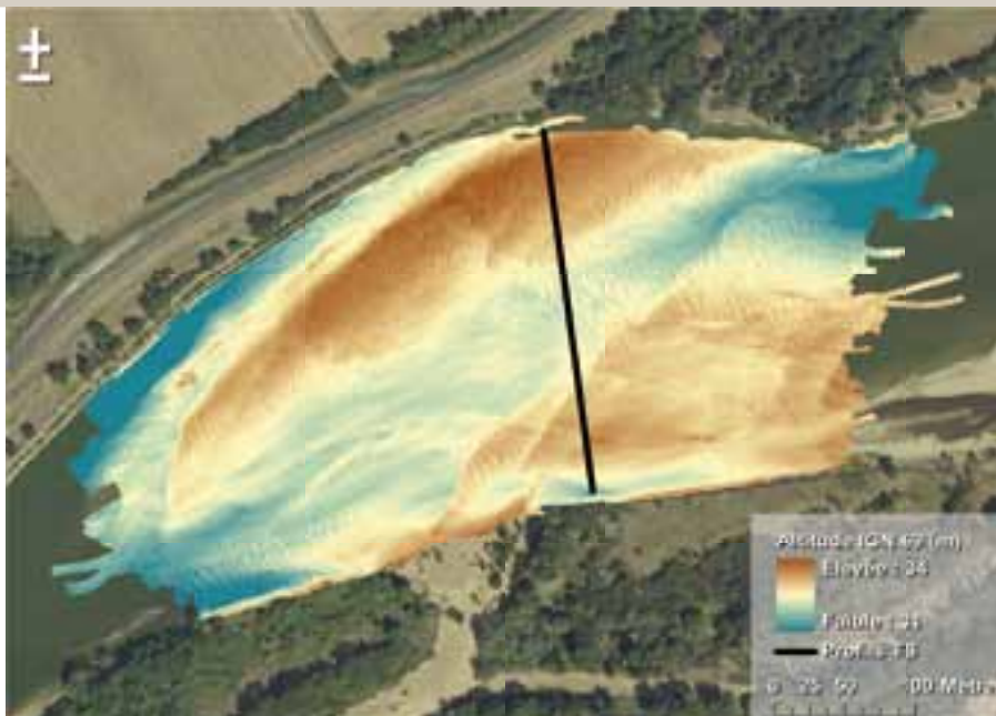
▲ Fig. 1 : Modèle d'élévation numérique obtenu par un levé bathymétrique multifaisceaux réalisé dans le secteur de Bréhémont (Indre-et-Loire). Deux barres sédimentaires (en marron) délimitées à l'aval par un front de progradation sont visibles ainsi que des dunes subaquatiques de second ordre (jaune clair). L'écoulement est orienté depuis l'Est vers l'Ouest et la droite noire correspond au profil de jaugeage solide (cf. figure 2 ).
